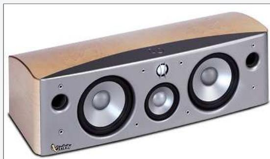
Der Kappa Center mit einer Nennimpedanz von 6 Ohm weist eine Nennbelastbarkeit von 80 und eine Musikbelastbarkeit von 120 Watt auf. Der Frequenzbereich beginnt bei 65 Hz und endet bei 27 kHz. Die Empfindlichkeit beträgt 90 dB (2,83 V/1 m). Bestückt ist der Center mit 2 x 170 mm C.M.M.D.®-Chassis -für den Tieftonbereich und mit einem 100 mm C.M.M.D.®-Mitteltöner. Um die Hochtonwiedergabe kümmert sich eine 25 mm C.M.M.D.®-Kalotte.
